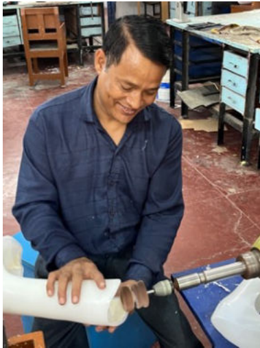
Vinod (links) am Fertigstellen einer Unterschenkelorthese.
